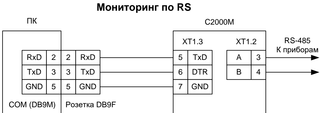
Рис. 10. Подключение пульта C2000/C2000M
